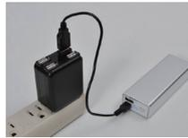
付属の接続ケーブルのmicroUSB 端子側を、本体の入力ポートへ、反対側の USB 端子を USB-AC アダプタなどに差して充電します。充電中バッテリー残量ランプが点滅し満充電で点灯になります。充電時間：約 2.5 時間
