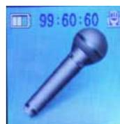
「モードボタン」を数回押すと写真の様な「音声録音モード」になります。音声録音モードスタンバイ時に「録画・撮影」ボタンを押すと録音が始まり画面上時間経過表示が赤色になり録音時間をカウントします。もう一度「録画・撮影」ボタンを押すと録音を停止し映像を記録します。また、スタンバイ状態の時に表示される数字はおおよその録音可能時間となります。
