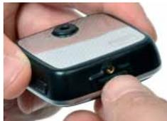
取り出す時は写真の様に指でmicroSDを押し込むと飛び出して来ます。
