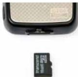
写真の向きの通りmicroSDを「カチッ」と音がするまで指で押し込んで下さい。
