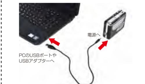
付属の電源ケーブルを使いPCのUSBコネクタと本機の電源口をつないで下さい。
