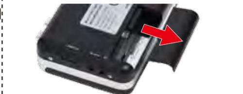
上の図の通り、本体裏の電池蓋を外して下さい。下の図の様に①～③の順に電池を1本ずつ入れて下さい。
