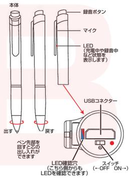
1. 下の写真のように本体を回して分離して下さい。
