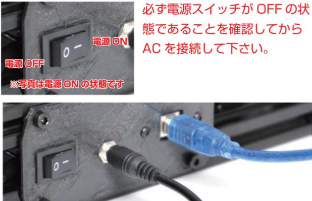
必ず電源スイッチが OFF の状態であることを確認してから AC を接続して下さい。
