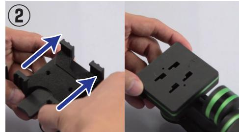
スマートフォンホルダーを矢印の方向へ押し上げ、外します。
