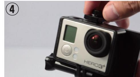
さらに、フレームをロックするネジを締めます。
