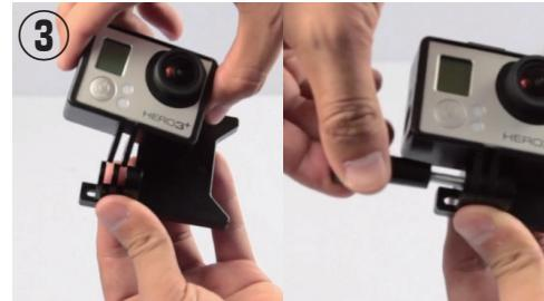
GoPro用ホルダーのプレートに、GoProを差し込み、ネジを締めてロックします。
