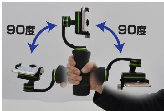
セッティング完了後、カメラは水平を保ち、手で持っているハンドルの先を常に向くように制御されます。
